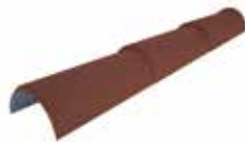
Møne 3-modul Buet Dimensjon: 1250x190x100 mm Dekkende mål: 1225 mm 200 stk./pall 2 kg/stk. 420 kg/pall
